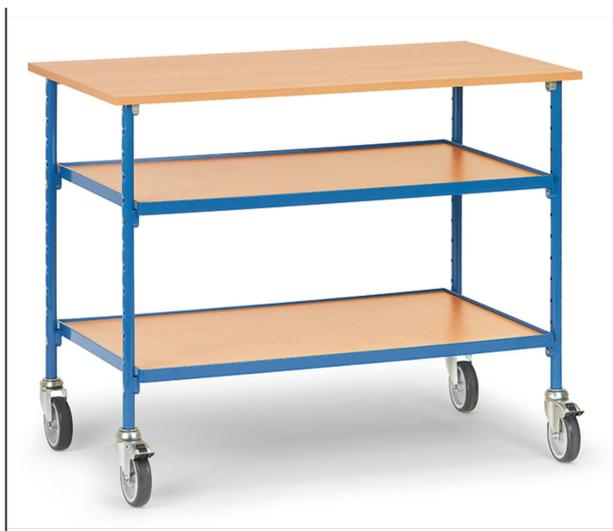
Ensemble mécano-soudé et boulonné, revêtement époxy bleu RAL 5007. Plan de travail en mélaminé renforcé épaisseur 20 mm, surface effet hêtre, 2 plateaux amovibles réglables au pas de 50 mm, compatible pour 1 hauteur de classeur. 4 roues pivotantes à bandage TPE, roulement à palier lisse. 2 roues avec freins. Charge maximum par plateau: 50 kg.
