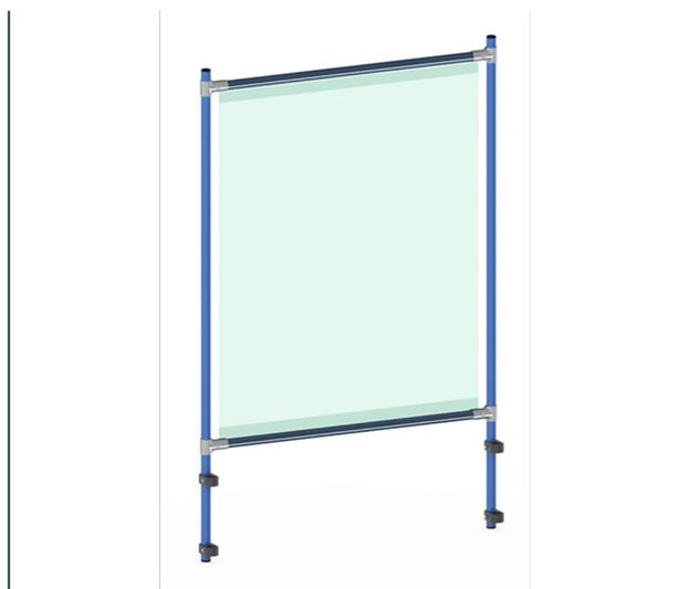
Armature de protection en tant que kit pour de nombreux équipements fetra. Ossature en tube d'acier à boulonner, avec revêtement époxy bleu RAL 5007, comme protection contre le coronavirus par exemple. Kit facile à monter au moyen d'attaches en plastique, même à postériori. Hauteur réglable permettant de laisser un passage à sa base.
