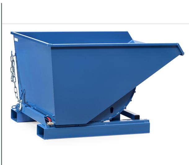
Construction robuste en tôle d'acier de 3 mm mécano-soudée et étanche. Revêtement époxy bleu RAL 5007. De série avec passage de fourches. Versement sans risque de basculement, verrouillage anti-ouverture et chaîne de sécurité. Système d'ouverture par câble ramené au siège du conducteur. Livrée avec câble. Robinet de vidange avec filtre pour séparer les liquides des solides, n° d'article complété par un A. Roues en option.
