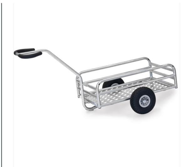
Chars à bras léger pour une utilisation en extérieur, en tube d'acier soudé, galvanisé, plateforme en tôle alu larmé, tubulure renforcée hauteur 180/250 mm. Timon sécurisé boulonné avec revêtement souple. Grandes roues gonflables, moyeu à roulement à rouleaux, fixation des roues par vis pour faciliter le remplacement.
