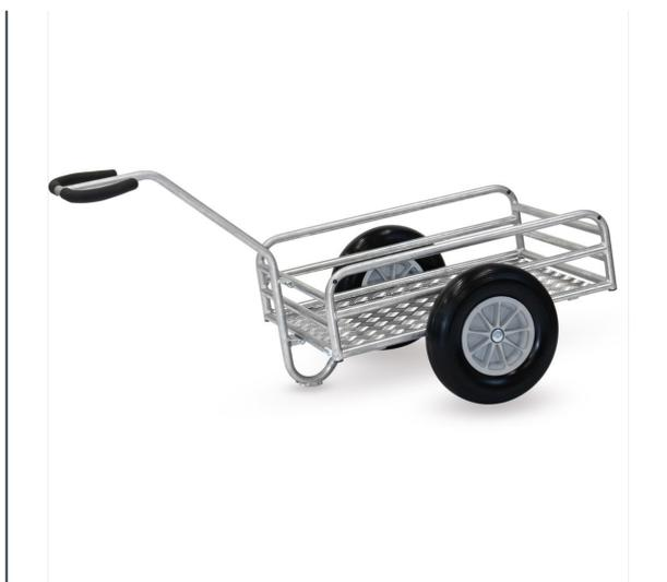
Chars à bras léger pour une utilisation en extérieur, en tube d'acier soudé, galvanisé, plateforme en tôle alu larmé, tubulure renforcée hauteur 180/250 mm. Timon sécurisé boulonné avec revêtement souple. Grandes roues mousse polyuréthane increvables, moyeu à roulement à rouleaux, fixation des roues par vis pour faciliter le remplacement.
