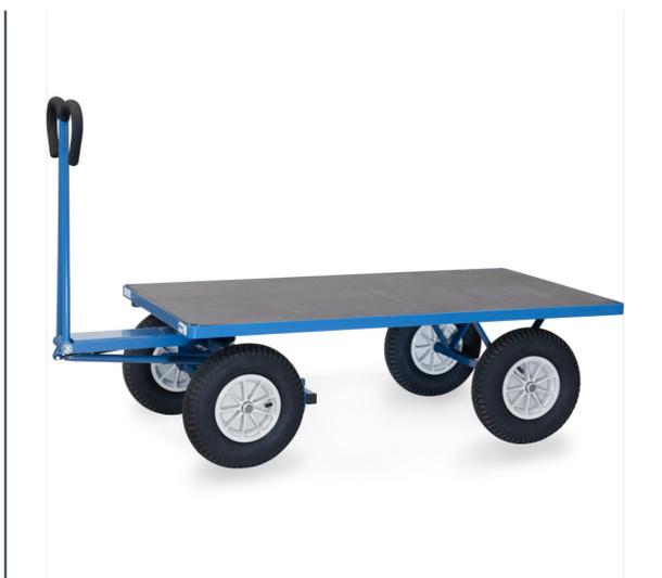
Ensemble mécano-soudé, revêtement époxy bleu RAL 5007. 4 inserts dans les angles, essieu sur rond à billes, timon en triangle avec poignée avec revêtement en plastique sécurisée remontant automatiquement en position verticale. Plateau en contreplaqué avec revêtement antidérapant et hydrofuge. Roues gonflables, moyeu à roulement à rouleaux. Freinage automatique sur essieu avant.
