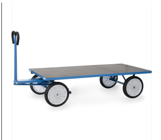
Ensemble mécano-soudé, revêtement époxy bleu RAL 5007. 4 inserts dans les angles, essieu sur rond à billes, timon en triangle avec poignée avec revêtement en plastique sécurisée remontant automatiquement en position verticale. Plateau en contreplaqué avec revêtement antidérapant et hydrofuge. Roues à bandage caoutchouc, moyeu à roulement à rouleaux. Freinage automatique sur essieu avant.
