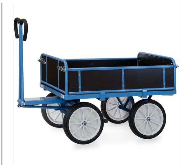
Ensemble mécano-soudé, revêtement époxy bleu RAL 5007. 4 inserts dans les angles, essieu sur rond à billes, timon en triangle avec poignée avec revêtement en plastique sécurisée remontant automatiquement en position verticale. Plateau en contreplaqué avec revêtement antidérapant et hydrofuge. 4 ridelles bois traité hydrofuge 250/325mm dont 3 côtés amovibles, longueur et largeur utiles -60 mm. Roues à bandage caoutchouc, moyeu à roulement à rouleaux. Freinage automatique sur essieu avant.
