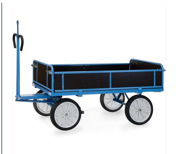
Ensemble mécano-soudé, revêtement époxy bleu RAL 5007. 4 inserts dans les angles, essieu sur rond à billes, timon en triangle avec poignée avec revêtement en plastique sécurisée remontant automatiquement en position verticale. Avec oeillet de traction, Ø interne 32 mm. Plateau en contreplaqué avec revêtement antidérapant et hydrofuge. Roues à bandage caoutchouc, moyeu à roulement à rouleaux. Freinage automatique sur essieu avant.
