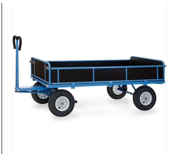
Ensemble mécano-soudé, revêtement époxy bleu RAL 5007. 4 inserts dans les angles, essieu sur rond à billes, timon en triangle avec poignée avec revêtement en plastique sécurisée remontant automatiquement en position verticale. Plateau en contreplaqué avec revêtement antidérapant et hydrofuge. 4 ridelles bois traité hydrofuge 250/325mm dont 3 côtés amovibles, longueur et largeur utiles -60 mm. Roues gonflables, moyeu à roulement à rouleaux. Freinage automatique sur essieu avant.
