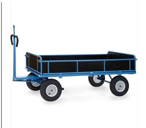
Ensemble mécano-soudé, revêtement époxy bleu RAL 5007. 4 inserts dans les angles, essieu sur rond à billes, timon en triangle avec poignée avec revêtement en plastique sécurisée remontant automatiquement en position verticale. Avec oeillet de traction, Ø interne 32 mm. Plateau en contreplaqué avec revêtement antidérapant et hydrofuge. Roues gonflables, moyeu à roulement à rouleaux. Freinage automatique sur essieu avant.
