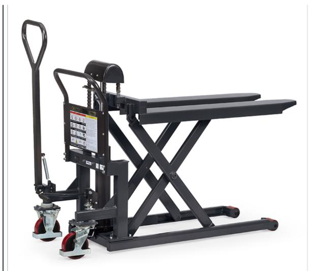
Très stable, peut être déplacé même chargé en position haute. Châssis et fourches en tôle d'acier, revêtement époxy anthracite RAL 7016. Dossier de poussée très solide, pompe hydraulique avec piston chromé, montée par pédale, descente par molette. 2 roues pivotantes avec freins. Version est en outre équipée d'un timon directeur.
