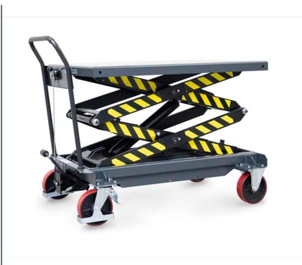
En acier soudé, revêtement époxy Gris Anthracite RAL 7016. Dossier de poussée fixe boulonné, pompe hydraulique à pédale. Vitesse de descente réglable. 2 roues fixes et 2 roues pivotantes à bandage en polyuréthane, moyeu à roulement à billes. Roues pivotantes avec freins.
