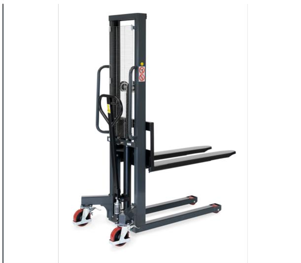
Construction très solide en tôle d'acier, avec dossier de poussée en tube d'acier, revêtement époxy Gris Anthracite RAL 7016. Système hydraulique à piston chromé. Montée en actionnant le timon, descente par gachette. 2 roues directionnelles à bandage polyuréthane avec freins 150 x 40 mm, et 2 boggies en polyuréthane 80 x 70 mm. Largeur de fourches: 160 mm. Montée par coup de timon: 20 mm. Hauteur totale: 2010 mm.
