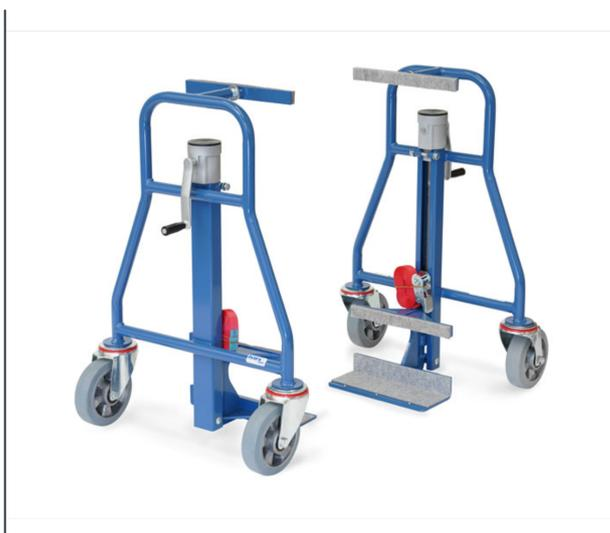
Construction en profilé et tube d'acier, revêtement époxy bleu RAL 5007. Treuil manuel à vis sans fin protégé par U en acier. Support de meuble avec revêtement en feutre. 2 roues pivotantes non traçantes confort Ø 160 x 50 mm, moyeu à roulement à billes. 1 sangle par diabie longueur 5 mètres. Hauteur en position basse: 10 mm. Levée: 300 mm. Dimensions extérieures (LxlxH): 600 x 390 x 800 mm. Livraison par paire.
