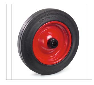
250 x 60 mm. Roue à bandage caoutchouc noir sur jante en tôle d'acier, moyeu à roulement à rouleaux.
