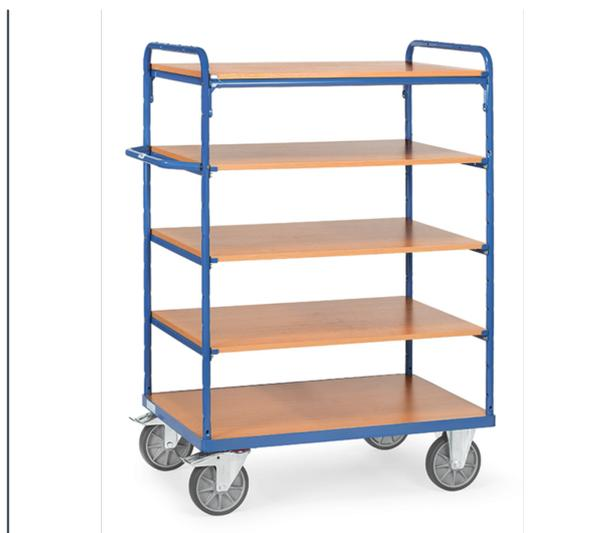
Ensemble mécano-soudé, revêtement époxy bleu RAL 5007. 1 plateau fixe et 4 amovibles en mélaminé surface effet hêtre. Plateaux amovibles réglables au pas de 100 mm. Charge maximum par plateau: 90 kg. 2 roues pivotantes et 2 roues fixes à bandage TPE, moyeu à roulement à billes central. Freins sur roues pivotantes.
