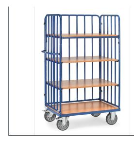
Ensemble mécano-soudé, revêtement époxy bleu RAL 5007. 1 plateau fixe et 3 amovibles en mélaminé surface effet hêtre. Ridelles avec tubes verticaux distancés de 130 mm. Plateaux amovibles réglables au pas de 100 mm. Charge maximum par plateau: 90 kg. 2 roues pivotantes et 2 roues fixes à bandage TPE, moyeu à roulement à billes central. Freins sur roues pivotantes.
