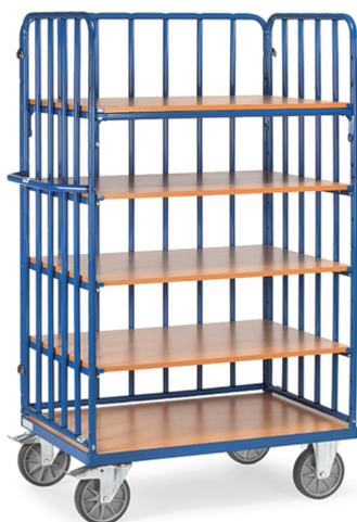
Ensemble mécano-soudé, revêtement époxy bleu RAL 5007. 1 plateau fixe et 4 amovibles en mélaminé surface effet hêtre. Ridelles avec tubes verticaux distancés de 130 mm. Plateaux réglables au pas de 100 mm. Charge maximum par plateau: 90 kg. 2 roues pivotantes et 2 roues fixes à bandage TPE, moyeu à roulement à billes central. Freins sur roues pivotantes.
