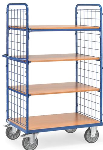
Ensemble mécano-soudé, revêtement époxy bleu RAL 5007. 1 plateau fixe et 3 amovibles en mélaminé surface effet hêtre. Ridelles avec treillis métallique 100 x 100 x 5 mm. Plateaux réglables au pas de 100 mm. Charge maximum par plateau: 90 kg. 2 roues fixes et 2 roues pivotantes à bandage TPE moyeu à roulement à billes central. Freins sur roues pivotantes.
