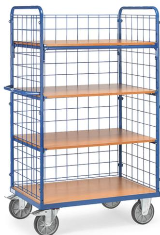
Ensemble mécano-soudé, revêtement époxy bleu RAL 5007. 1 plateau fixe et 3 amovibles en mélaminé surface effet hêtre. 2 petits et 1 grand côté avec treillis métallique 100 x 100 x 5 mm. Plateaux réglables au pas de 100 mm. Charge maximum par plateau: 90 kg. 2 roues fixes et 2 roues pivotantes à bandage TPE, moyeu à roulement à billes central. Freins sur roues pivotantes.
