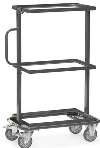
Construction conductrice d'électricité (ESD=electrostatic Discharge). En profilé et tube d'acier soudé, revêtement époxy conducteur d'électricité gris ardoise RAL 7015. Plateaux en mélaminé conducteurs d'électricité conformément à la Norme 68765, gris clair. 2 roues pivotantes et 2 roues fixes à bandage TPE-ESD, conductrices d'électricité, moyeu à roulement à bille central. Freins sur roues pivotantes. Charge plateau haut et intermédiaire: 50 kg. Armature ouverte sans plateaux.
