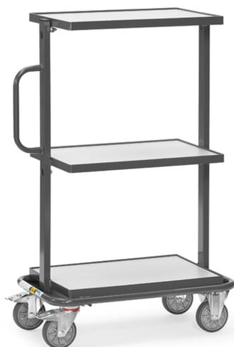
En profilé et tube d'acier soudé, revêtement époxy conducteur d'électricité gris ardoise RAL 7015. Plateaux en mélaminé conducteurs d'électricité conformément à la Norme 68765, gris clair. 2 roues pivotantes et 2 roues fixes à bandage TPE-ESD, conductrices d'électricité, moyeu à roulement à bille central. Freins sur roues pivotantes. Charge plateau haut et intermédiaire: 50 kg. Avec 3 plateaux en mélaminé conducteurs d'électricité, rebord de 7 mm.
