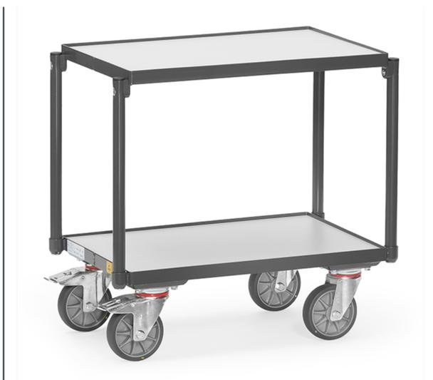
En profilé et tube d'acier soudé, revêtement époxy conducteur d'électricité gris ardoise RAL 7015. Plateaux en mélaminé conducteurs d'électricité conformément à la Norme 68765, gris clair. 4 roues pivotantes à bandage TPE-ESD, conductrices d'électricité, moyeu à roulement à bille central. 2 roues avec freins. Charge plateau haut: 100 kg. Avec 2 plateaux en mélaminé conducteurs d'électricité, rebord de 7 mm. Distance entre les plateaux: 400 mm. Compatible pour bacs plastiques 600 x 400 mm.
