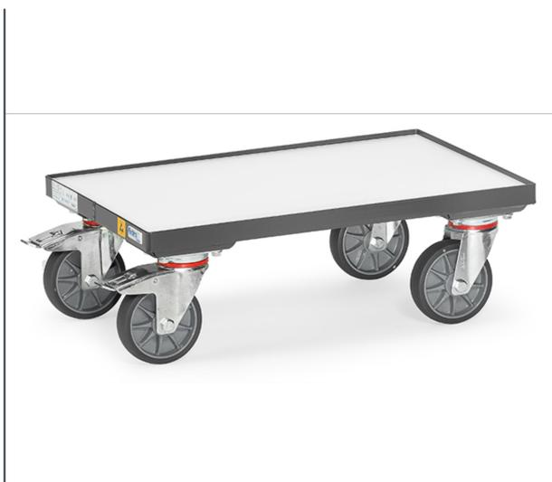
En profilé et tube d'acier soudé, revêtement époxy conducteur d'électricité gris ardoise RAL 7015. Plateaux en mélaminé conducteurs d'électricité conformément à la Norme 68765, gris clair. 4 roues pivotantes à bandage TPE-ESD, conductrices d'électricité, moyeu à roulement à bille central. 2 roues avec freins. Avec dossier de poussée. Avec plateaux en mélaminé conducteurs d'électricité, rebord de 7 mm. Compatible pour bacs plastiques 600 x 400 mm.
