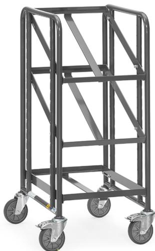
En profilé et tube d'acier soudé, revêtement époxy conducteur d'électricité gris ardoise RAL 7015. 3 plateaux amovibles en profilé avec armature ouverte pour 1 bac plastique 600 x 400 mm. Plateaux réglables au pas de 50 mm et inclinables de 15° et 30°. Charge plateau haut et intermédiaire: 80 kg. 4 roues pivotantes à bandage TPE-ESD, conductrices d'électricité, moyeu à roulement à bille central. 2 roues avec freins.
