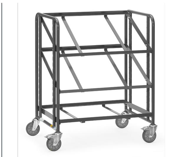
En profilé et tube d'acier soudé, revêtement époxy conducteur d'électricité gris ardoise RAL 7015. 3 plateaux amovibles en profilé avec armature ouverte pour 2 bac plastique 600 x 400 mm. Plateaux réglables au pas de 50 mm et inclinables de 15° et 30°. Charge plateau haut et intermédiaire: 80 kg. 4 roues pivotantes à bandage TPE-ESD, conductrices d'électricité, moyeu à roulement à bille central. 2 roues avec freins.
