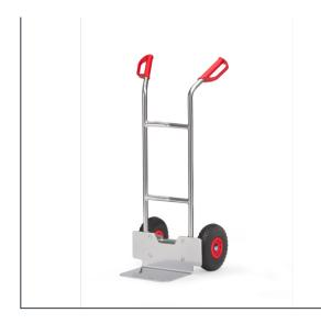
Ensemble mécano-soudé en aluminium. Soigneusement soudé sans revêtement, léger et maniable. Poignées de sécurité en plastique dur. Tablier cintré permettant d'embarquer des éléments ronds tels que rouleaux, bidons, seaux etc. Bavette en tôle d'alu à boulonner et remplaçable. Roues en mousse polyuréthane increvables, moyeu à roulement à rouleaux. Livré avec bavette démontée.
