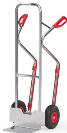
Ensemble mécano-soudé en aluminium. Soigneusement soudé sans revêtement, léger et maniable. Poignées de sécurité en plastique dur et patins amovibles. Tablier cintré permettant d'embarquer des éléments ronds tels que rouleaux, bidons, seaux etc. Bavette en tôle d'alu à boulonner et remplaçable. Roues en mousse polyuréthane increvables, moyeu à roulement à rouleaux. Livré avec bavette démontée.
