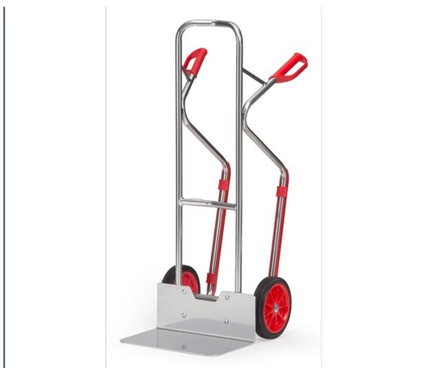
Ensemble mécano-soudé en aluminium. Soigneusement soudé sans revêtement, léger et maniable. Poignées de sécurité en plastique dur et patins amovibles. Tablier cintré permettant d'embarquer des éléments ronds tels que rouleaux, bidons, seaux etc. Bavette en tôle d'alu à boulonner et remplaçable. Roues à bandage caoutchouc, moyeu à roulement à rouleaux. Livré avec bavette démontée.
