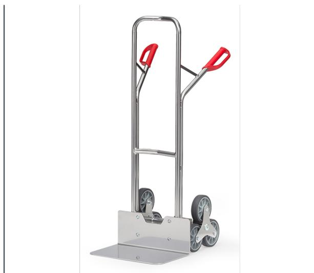
Ensemble mécano-soudé en aluminium. Poignées de sécurité en plastique dur avec arceaux de sécurité. Tablier cintré permettant d'embarquer des éléments ronds tels que rouleaux, bidons, seaux etc. Bavette en tôle d'aluminium à boulonner et remplaçable. Roues en étoiles composées de 2 fois 3 roues à bandage TPE Ø 160 mm.
