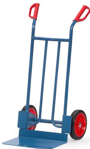
Ensemble mécano-soudé en tube et tôle d'acier, revêtement époxy bleu RAL 5007. Poignées de sécurité en plastique dur avec arceaux de sécurité. Bavette en tôle d'acier à boulonner et remplaçable. Roues à bandage caoutchouc, moyeu à roulement à rouleaux. Livré avec bavette démontée.
