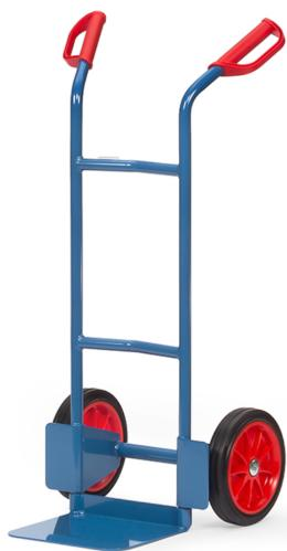
Ensemble mécano-soudé en tube et tôle d'acier, revêtement époxy bleu RAL 5007. Poignées de sécurité en plastique dur avec arceaux de sécurité. Bavette en tôle d'acier à boulonner et remplaçable. Roues à bandage caoutchouc, moyeu à roulement à rouleaux. Tablier cintré permettant d'embarquer des éléments ronds tels que rouleaux, bidons, seaux etc. Livré avec bavette démontée.
