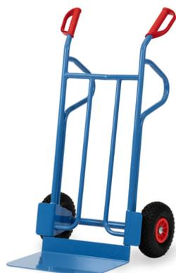
Ensemble mécano-soudé en tube et tôle d'acier, revêtement époxy bleu RAL 5007. Poignées de sécurité en plastique dur avec arceaux de sécurité. Bavette en tôle d'acier à boulonner et remplaçable. Roues en mousse polyuréthane increvables, moyeu à roulement à rouleaux. Livré avec bavette démontée.
