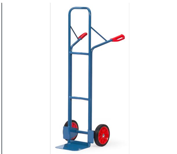
Ensemble mécano-soudé en tube et tôle d'acier, revêtement époxy bleu RAL 5007. Poignées de sécurité en plastique dur avec arceaux de sécurité. Bavette en tôle d'acier à boulonner et remplaçable. Roues à bandage caoutchouc, moyeu à roulement à rouleaux. Tablier cintré permettant d'embarquer des éléments ronds tels que rouleaux, bidons, seaux etc. Livré avec bavette démontée.
