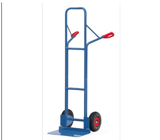
Ensemble mécano-soudé en tube et tôle d'acier, revêtement époxy bleu RAL 5007. Poignées de sécurité en plastique dur avec arceaux de sécurité. Bavette en tôle d'acier à boulonner et remplaçable. Roues gonflables, moyeu à roulement à rouleaux. Tablier cintré permettant d'embarquer des éléments ronds tels que rouleaux, bidons, seaux etc. Livré avec bavette démontée.
