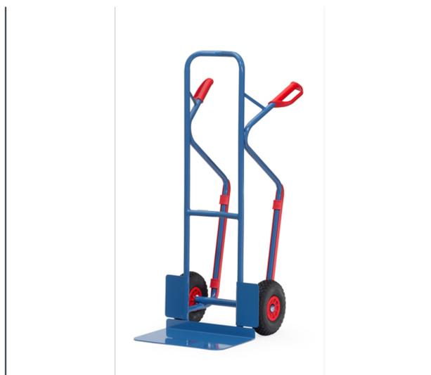
Ensemble mécano-soudé en tube et tôle d'acier, revêtement époxy bleu RAL 5007. Poignées de sécurité en plastique dur avec arceaux de sécurité et patins amovibles. Bavette en tôle d'acier à boulonner et remplaçable. Roues en mousse polyuréthane increvables, moyeu à roulement à rouleaux. Tablier cintré permettant d'embarquer des éléments ronds tels que rouleaux, bidons, seaux etc. Livré avec bavette démontée.
