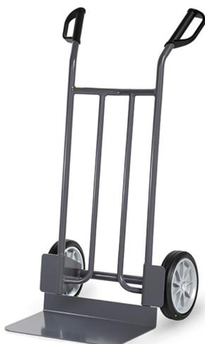
Tous les éléments sont conducteurs d'électricité. Ensemble mécano-soudé en tube et tôle d'acier, revêtement époxy gris foncé RAL 7015. ESD-poignées de sécurité en plastique dur avec arceaux de sécurité. Bavette en tôle d'acier vissé et remplaçable. Roues à bandage ESD-caoutchouc, moyeu à roulement à rouleaux.
