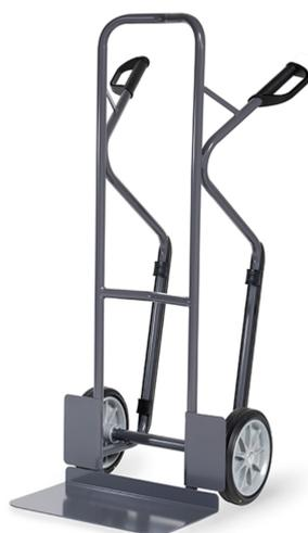
Tous les éléments sont conducteurs d'électricité. Ensemble mécano-soudé en tube et tôle d'acier, revêtement époxy gris foncé RAL 7015. ESD-poignées de sécurité en plastique dur avec arceaux de sécurité. Bavette en tôle d'acier vissé et remplaçable. Roues à bandage ESD-caoutchouc, moyeu à roulement à rouleaux. Tablier cintré permettant d'embarquer des éléments ronds tels que rouleaux, bidons, seaux etc.
