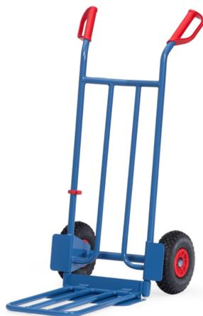
Ensemble mécano-soudé en tube d'acier, revêtement époxy bleu RAL 5007. Tablier cintré permettant d'embarquer des éléments ronds tels que rouleaux, bidons, seaux etc. Bavette fixe et rabattable 500 x 330 mm, poignées de sécurité en plastique dur avec arceaux de sécurité. Roues en mousse polyuréthane increvables sur jante en plastique, moyeu à roulement à rouleaux. Livré avec bavette démontée.
