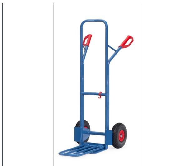
Ensemble mécano-soudé en tube d'acier, revêtement époxy bleu RAL 5007. Tablier cintré permettant d'embarquer des éléments ronds tels que rouleaux, bidons, seaux etc. Bavette fixe et rabattable 500 x 250 mm, poignées de sécurité en plastique dur avec arceaux de sécurité. Roues en mousse polyuréthane increvables sur jante en plastique, moyeu à roulement à rouleaux. Livré avec bavette démontée.
