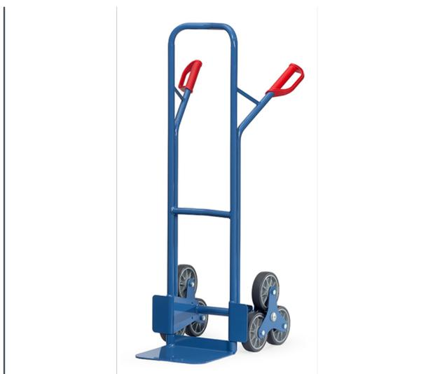
Ensemble mécano-soudé en tube et tôle d'acier, revêtement époxy bleu RAL 5007. Poignées de sécurité en plastique dur avec arceaux de sécurité. Tablier cintré permettant d'embarquer des éléments ronds tels que rouleaux, bidons, seaux etc. Bavette en tôle d'acier à boulonner et remplaçable. Roues en étoiles composées de 3 roulettes à bandage TPE Ø 160 mm.
