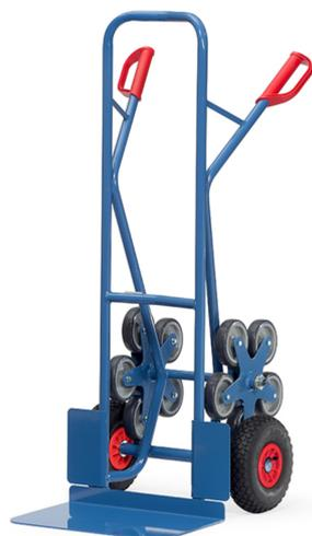
Ensemble mécano-soudé en tube et tôle d'acier, revêtement époxy bleu RAL 5007. Poignées de sécurité en plastique dur avec arceaux de sécurité. Tablier cintré permettant d'embarquer des éléments ronds tels que rouleaux, bidons, seaux etc. Bavette en tôle d'acier à boulonner et remplaçable. Roues gonflables et 2 branches avec 5 roulettes à bandage TPE Ø 125 mm en étoile.
