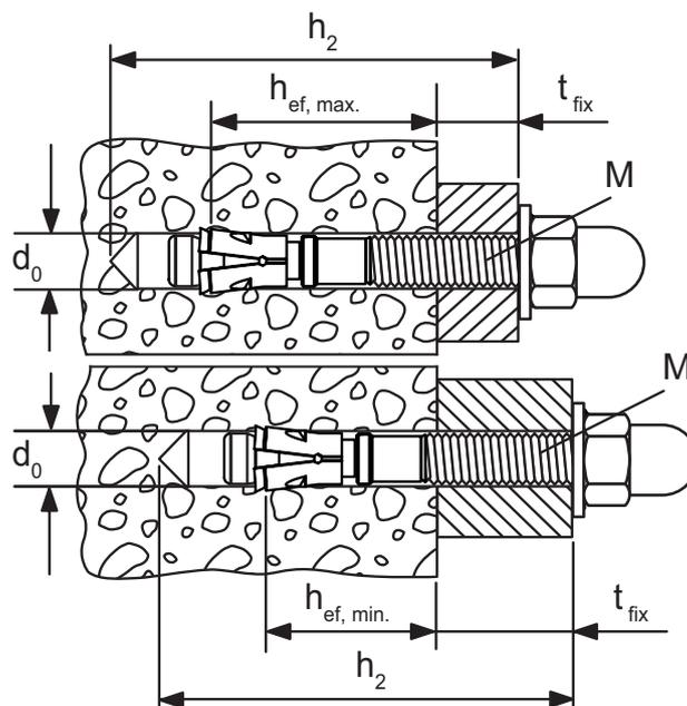
\*Das Anbauteil muss im Bereich der Verdübelung vor der Montage direkt am Beton anliegen.
