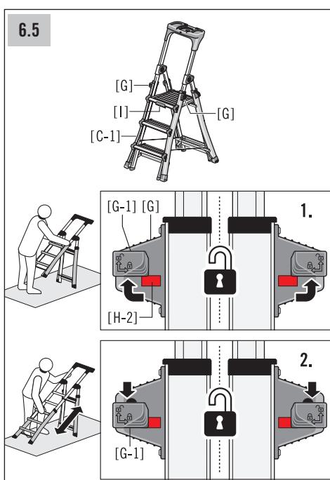
1. 脚柱 [C-1] の両ガイドレールにあるロック解除ボタン [G-1] を外側に、そして上にスライドさせます。
