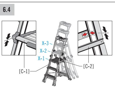
1. Odblokovací tlačítka [G-1] na obou vodicích lištách bočnice [C-1] posuňte směrem ven a poté nahoru. Je vidět „ČERVENÁ“ indikace zajištění [H-2]. Bočnice je nyní odjištěná a je možné ji posunout.
