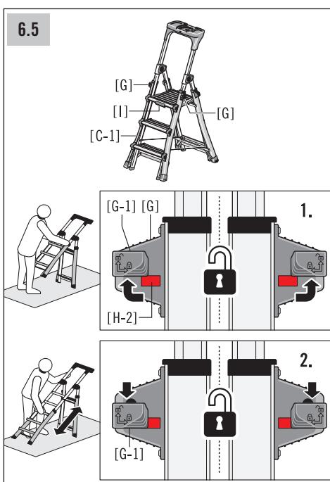
1. Placez les boutons de déverrouillage [G-1] sur les deux rails de guidage du montant [C-1] vers l'extérieur, puis vers le haut.
