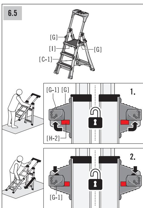
1. Entriegelungstasten [G-1] an beiden Führungs- schienen des Leiterschenkels [C-1] nach außen und anschließend nach oben stellen.
