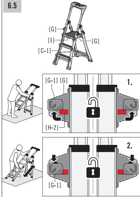
3. 梯腿 [C-1] 在规定的锁定位置自动锁定。可听到调整单元 [G] 的锁定螺栓自动在规定的孔中锁紧的声响。
