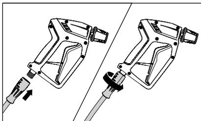
3. Applicare il collegamento a vite girevole grigio del tubo flessibile ad alta pressione sulla pistola ad arresto automatico e serrarli tra loro saldamente e a tenuta di pressione.
