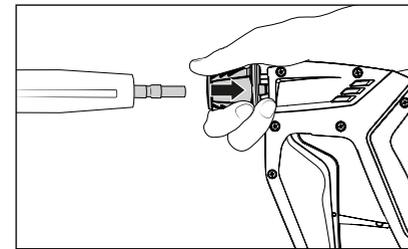
4. Arretrare dapprima il manicotto di bloccaggio della pistola ad arresto automatico ed inserire quindi la lancia nella connessione a innesto della pistola ad arresto automatico.
