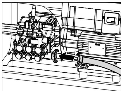
1. Montare il tubo di aspirazione con filtro di aspirazione (Art. n°: 150383).
