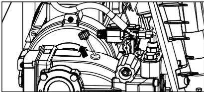
7. **Prima di ogni messa in servizio si deve controllare l'asta di livello dell'olio.** Il livello dell'olio deve raggiungere almeno il bordo superiore della marca.
