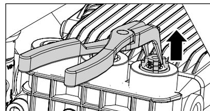
Rimuovere la vite con il corpo della valvola e l'anello di tenuta. Controllare che l'anello di tenuta non sia danneggiato. Sostituire gli anelli di tenuta eventualmente danneggiati.
