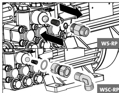
Rimuovere il corpo della valvola antiritorno e controllare che la valvola non sia imbrattata o danneggiata. Controllare anche che la sede della tenuta nel corpo della pompa non sia imbrattato o danneggiato.
