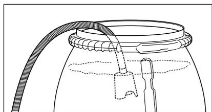
2. Agganciare con tubo flessibile pieno d'acqua nel contenitore riempito d'acqua e iniziare il processo di depurazione. **Fare attenzione a che l'acqua sia pulita! Non aspirare acqua contenente cloro! Non aspirare aria!**
