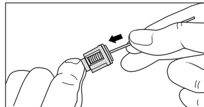
Pulire le valvole con un filo metallico (fermaglio), possibilmente sotto acqua corrente. Non dimenticare la guarnizione anulare nella fase di rimontaggio!
