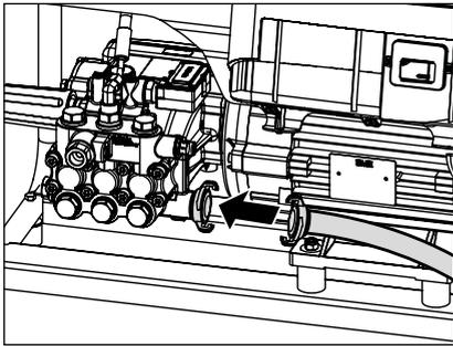
6. Collegare il flessibile dell'acqua al filtro di ingresso dell'acqua. L'idropulitrice può essere collegata a scelta a una tubazione ad alta pressione (pressione di mandata: 1 - 10 bar) per acqua fredda o per acqua riscaldata fino a 60° C. Le idropultrici di questa serie offrono la possibilità di aspirare l'acqua da un contenitore/serbatoio esterno (vedere aspirazione diretta).
