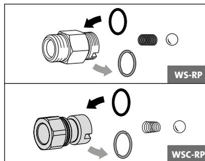
Gli anelli di tenuta difettosi vanno sostituiti senza indugio.
