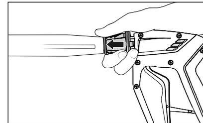
5. Dopo aver inserito la lancia rilasciare il manicotto di bloccaggio e controllare il fissaggio sicuro della lancia.
