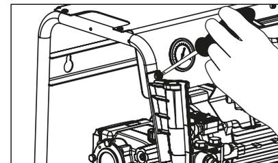
Fissare i supporti delle lance utilizzando un cacciavite e le viti fornite in dotazione.
