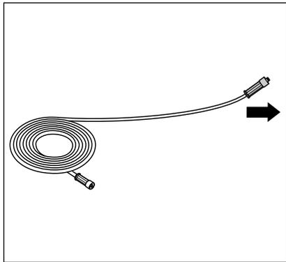
1. Srotolare il tubo flessibile ad alta pressione in modo che segua un percorso dritto e privo di anse. (In caso di prolunga del tubo flessibile ad alta pressione è necessario rispettare la lunghezza massima di 20 m!) Il tubo flessibile ad alta pressione può lasciare tracce di abrasione su alcuni tipi di pavimenti. La nostra gamma di prodotti comprende, quale alternativa, anche tubi flessibili AP di tipo Non-Marking.
