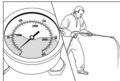
La pressione è regolata sul valore massimo, ma il manometro in acciaio inox indica solo una pressione bassa. Dalla lancia fuoriesce un getto irregolare. Il tubo flessibile ad alta pressione vibra. (Nel manometro in acciaio inox non si trova acqua, si tratta di glicerina per ammortizzare le vibrazioni della lancetta.)
