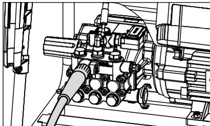
2. Il tubo flessibile ad alta pressione fornito in dotazione alle idropultrici senza avvolgitubo deve essere avvitato saldamente e a prova di pressione sul raccordo di uscita della pompa.
