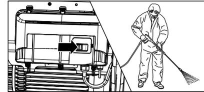
9. Avviare l'idropulitrice ad alta pressione mantenendo aperta la pistola ad arresto automatico. Disaerazione dell'idropultrice: Aprire e chiudere ripetutamente la pistola ad arresto automatico. Dopodiché si può iniziare il processo di pulizia.
