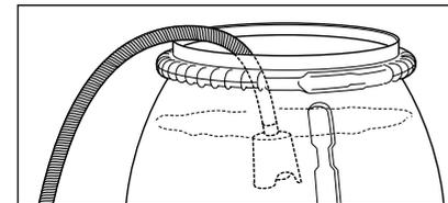
3. Agganciare con tubo flessibile pieno d'acqua nel contenitore riempito d'acqua e iniziare il processo di depurazione. **Fare attenzione a che l'acqua sia pulita! Non aspirare acqua contenente cloro! Non aspirare aria!**
