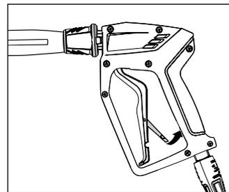
Dopo ogni uso si deve attivare la sicura della pistola ad arresto automatico, in modo da poter escludere la possibilità di spruzzi accidentali!
