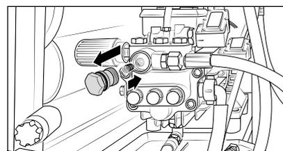
Rimuovere il corpo della valvola antiritorno e controllare che la valvola non sia imbrattata o danneggiata. Controllare anche che la sede della tenuta nel corpo della pompa non sia imbrattato o danneggiato.
