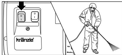
2. Avviare l'idropulitrice ad alta pressione mantenendo aperta la pistola ad arresto automatico. Disaerazione dell'idropulitrice: Aprire e chiudere ripetutamente la pistola ad arresto automatico.
