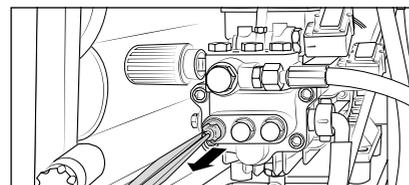
Pulire le valvole con un filo metallico (fermaglio), possibilmente sotto acqua corrente.
