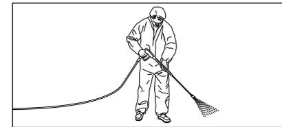
3. All'inizio dell'operazione di lavaggio **non** dirigere il getto ad alta pressione sull'oggetto da lavare per almeno 30 secondi. È possibile che il contenuto d'acqua della serpentina di riscaldamento abbia cambiato colore in seguito al tempo di riposo.
