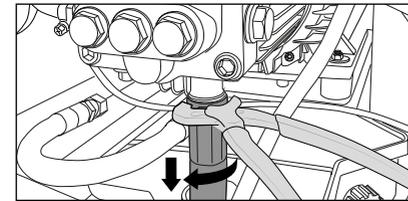
1. Svitare il tubo flessibile di collegamento tra la pompa ad alta pressione e il serbatoio dell'acqua.
