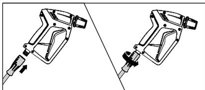
7. Applicare il collegamento a vite girevole grigio del tubo flessibile ad alta pressione sulla pistola ad arresto automatico e serrarli tra loro saldamente e a tenuta di pressione.
