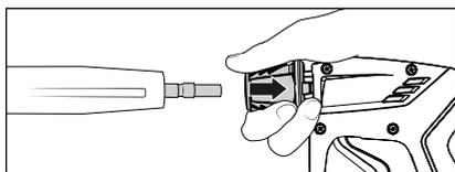
8. Arretrare dapprima il manicotto di bloccaggio della pistola ad arresto automatico ed inserire quindi la lancia nella connessione a innesto della pistola ad arresto automatico.
