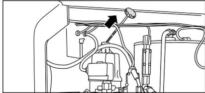
13. **Prima di ogni messa in servizio si deve controllare l'asta di livello dell'olio.** Il livello dell'olio deve raggiungere almeno il bordo superiore della marca "OK". Vedere capitolo „Cura e manutenzione“ nelle presenti istruzioni per l'uso.
