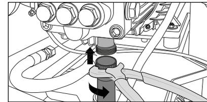
2. Collegare il tubo flessibile con filtro di aspirazione (Art. n°: 150383) al tubo flessibile di collegamento, utilizzando a tale scopo un doppio nipplo (Art. n°: 46004).
