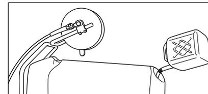
3. Prima della messa in servizio si deve eseguire il rifornimento del serbatoio con olio combustibile. Olio combustibile (EL DIN 51 603) o gasolio (DIN EN 590). Quantità: 25 litri.
