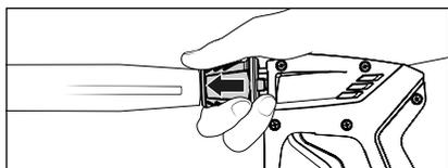
9. Dopo aver inserito la lancia rilasciare il manicotto di bloccaggio e controllare il fissaggio sicuro della lancia. **Lubrificare regolarmente il nipplo a innesto con un grasso privo di acidi.**
