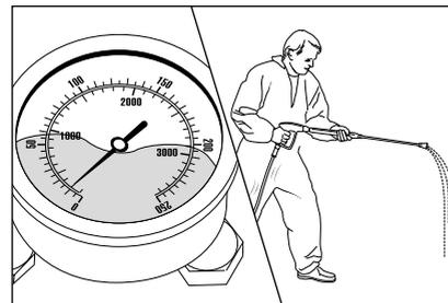
La pressione è regolata sul valore massimo, ma il manometro in acciaio inox indica solo una pressione bassa. Dalla lancia fuoriesce un getto irregolare. Il tubo flessibile ad alta pressione vibra.
