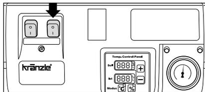
4. Inserire Interruttore del riscaldamento. L'acqua viene quindi riscaldata e mantenuta costante sulla temperatura impostata. Dopodiché si può iniziare il processo di pulizia.
