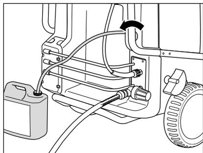
1. Inserire il filtro chimico nel contenitore dell'additivo.
