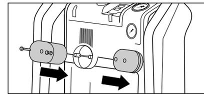
1. Montare con le viti i supporti del cavo di rete.
