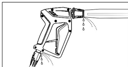
Disinserire l'idropultrice. Scaricare la pressione azionando brevemente la pistola ad arresto automatico. Rimuovere il tubo flessibile ad alta pressione, la pistola ad arresto automatico e la lancia e controllare gli anelli di tenuta. Sostituire subito gli anelli di tenuta eventualmente difettosi.
