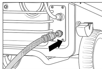
11. Il flessibile dell'acqua deve essere collegato al rispettivo ingresso dell'acqua. (Requisiti minimi: lunghezza tubo flessibile: 5 m, sezione trasversale: 3/4", 10 bar). L'idropultrice può essere collegata a scelta a una tubazione ad alta pressione (pressione di mandata: 1 - 10 bar) per acqua fredda o per acqua riscaldata fino a 60° C.
