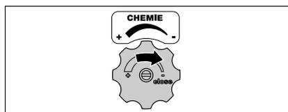
3. L'alimentazione dell'additivo viene interrotta chiudendo la valvola del detergente.
