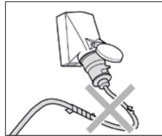
Il cavo di alimentazione deve essere utilizzato solo se in perfetto stato! Evitare danneggiamenti del cavo di allacciamento (strappi o schiacciamenti, passaggio di veicoli, ...) e riparazioni non appropriate!
