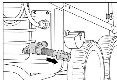
10. **Prima di ogni messa in servizio si deve controllare il grado di intasamento del filtro d'ingresso dell'acqua.** Svitare manualmente la tazza del filtro, rimuovere il filtro d'ingresso dell'acqua. Sciacquare quindi abbondantemente con acqua pulita gli ulteriori componenti e pulirli. Se il filtro è intasato, l'acqua non può defluire e la pressione non può essere generata.
