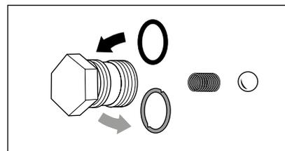
Gli anelli di tenuta difettosi vanno sostituiti senza indugio.
