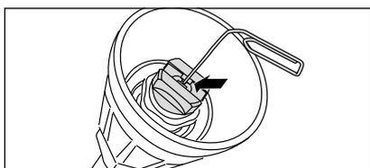
Se il problema persiste, disintasarne con cautela il foro dell'ugello utilizzando un filo metallico (fermaglio). Sostituire l'ugello se la pulizia con filo metallico non produce l'effetto desiderato.
