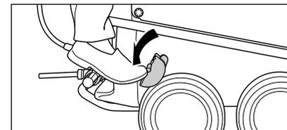
4. Allentare il freno di stazionamento prima di muovere l'idropulitrice in direzione del luogo d'impiego.
