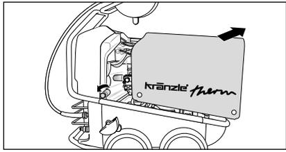
12. Per accedere ai componenti interni dell'idropulitrice è necessario svitare le viti presenti sul coperchio. Rimuovere con cautela il coperchio. **Chiudere correttamente il coperchio prima di iniziare il lavaggio.**
