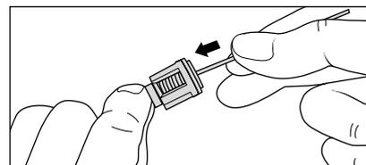
Non dimenticare la guarnizione anulare nella fase di rimontaggio!
