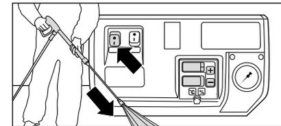
2. Avviare l'idropulitrice ad alta pressione mantenendo aperta la pistola ad arresto automatico. Disaerazione dell'idropulitrice: Aprire e chiudere ripetutamente la pistola ad arresto automatico. Dopodiché si può iniziare il processo di pulizia.
