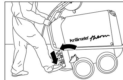
5. Queste idropultrici sono dotate di un carrello robusto, adatto per ogni tipo di terreno. L'idropultrice può essere manovrata puntando un piede contro l'elemento antiribaltamento e tirando verso di sé l'idropultrice.
