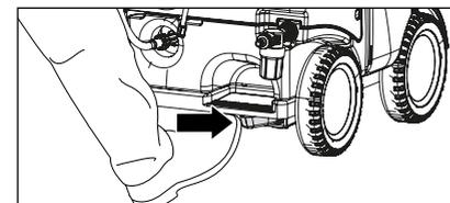
4. Allentare il freno di stazionamento prima di muovere l'idropulitrice in direzione del luogo d'impiego. L'idropulitrice non va trainata con flessibile di alimentazione dell'acqua allacciato!
