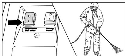
3. Avviare l'idropulitrice ad alta pressione mantenendo aperta la pistola ad arresto automatico. Disaerazione della macchina: aprire e chiudere ripetutamente la pistola ad arresto automatico.
