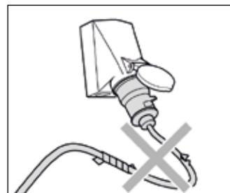
Il cavo di alimentazione deve essere utilizzato solo se in perfetto stato! Evitare danneggiamenti del cavo di allacciamento (strappi o schiacciamenti, passaggio di veicoli, ...) e riparazioni non appropriate!
