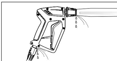
Disinserire l'idropulitrice. Scaricare la pressione azionando brevemente la pistola ad arresto automatico. Rimuovere il tubo flessibile ad alta pressione, la pistola ad arresto automatico e la lancia e controllare gli anelli di tenuta. Sostituire subito gli anelli di tenuta eventualmente difettosi.
