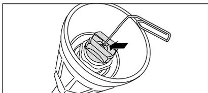
Se il problema persiste, disintasare con cautela il foro dell'ugello utilizzando un filo metallico (fermaglio). Sostituire l'ugello se la pulizia con filo metallico non produce l'effetto desiderato.
