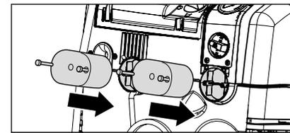
1. Montare con le viti i supporti del cavo di rete.
