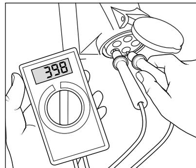
Un numero eccessivo di utenze collegate alla rete elettrica locale può comportare un notevole calo della tensione ed intensità di corrente disponibili, causando di conseguenza un mancato avviamento o una bruciatura del motore. Un'incorretta alimentazione di corrente può essere causata anche da un cavo elettrico troppo lungo o troppo sottile. Cavi di prolunga eccessivamente lunghi causano cadute di tensione e conseguenti malfunzionamenti e problemi di avviamento.
