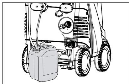
1. Reinigungsmittelinjektorschlauch in Behälter mit Zusatzmittel stecken.
