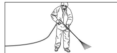
4. All'inizio dell'operazione di lavaggio **non** dirigere il getto ad alta pressione sull'oggetto da lavare per almeno 30 secondi. È possibile che il contenuto d'acqua della serpentina di riscaldamento abbia cambiato colore in seguito al tempo di riposo.
