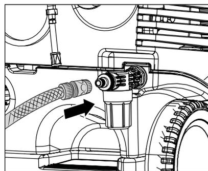
11. Il flessibile dell'acqua deve essere collegato al rispettivo ingresso dell'acqua. (Requisiti minimi: lunghezza tubo flessibile: 5 m, sezione trasversale: 3/4", 10 bar). L'idropultrice può essere collegata a scelta a una tubazione ad alta pressione (pressione di mandata: 1 - 10 bar) per acqua fredda o per acqua riscaldata fino a 60° C. Le idropultrici di questa serie offrono la possibilità di aspirare l'acqua da un contenitore/serbatoio esterno (vedere aspirazione diretta).
