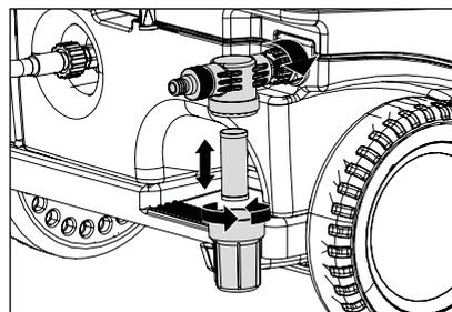
10. Prima di ogni messa in servizio si deve controllare il grado di intasamento del filtro d'ingresso dell'acqua. Svitare manualmente la tazza del filtro, rimuovere il filtro d'ingresso dell'acqua. Sciacquare quindi abbondantemente con acqua pulita gli ulteriori componenti e pulirli. Se il filtro è intasato, l'acqua non può defluire e la pressione non può essere generata.
