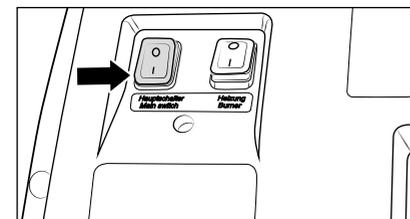
3. Avviare l'idropulitrice ad alta pressione mantenendo aperta la pistola ad arresto automatico. Disaerazione dell'idropulitrice: Disaerazione della macchina: aprire e chiudere ripetutamente la pistola ad arresto automatico. Dopodiché si può iniziare il processo di pulizia.
