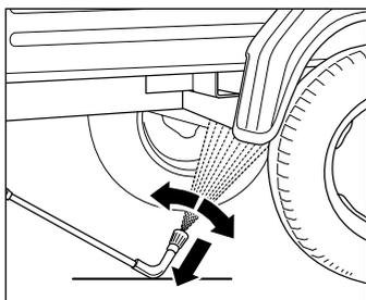
Appoggiare assolutamente la lancia per sottoscocca durante l'uso! Nell'uso della lancia per sottoscocca tenere presente che in caso di lance a spruzzo leggermente curve risp. angolate si verifica una considerevole coppia nel contraccolpo! (La lancia per sottoscocca è un accessorio opzionale.)
