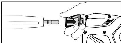
8. Arretrare dapprima il manicotto di bloccaggio della pistola ad arresto automatico ed inserire quindi la lancia nella connessione a innesto della pistola ad arresto automatico.
