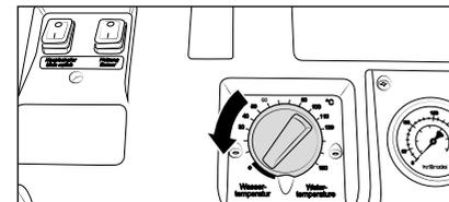
1. Regolare la temperatura su "0" mediante il termostato.
