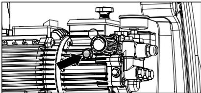
13. **Prima di ogni messa in servizio si deve controllare il tubo d'ispezione del livello dell'olio.**
