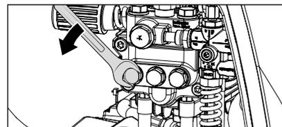
Rimuovere la vite con il corpo della valvola e l'anello di tenuta. Controllare che l'anello di tenuta non sia danneggiato. Sostituire gli anelli di tenuta eventualmente danneggiati.
