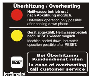
**Rosso:** Disinserimento da sovratemperatura, lasciare raffreddare l'apparecchio. La pulizia ad acqua calda non è eseguibile.
