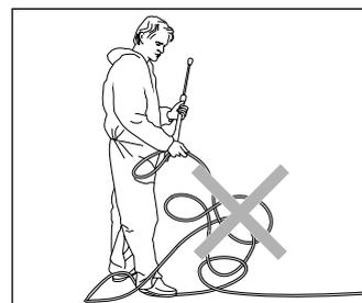
Non piegare eccessivamente il tubo flessibile ad alta pressione e tirarlo diritto, ossia senza formazioni di anse! Non tirare il tubo flessibile ad alta pressione facendolo passare sopra a spigoli vivi!
