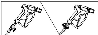
7. Applicare il collegamento a vite girevole grigio del tubo flessibile ad alta pressione sulla pistola ad arresto automatico e serrarli tra loro saldamente e a tenuta di pressione.
