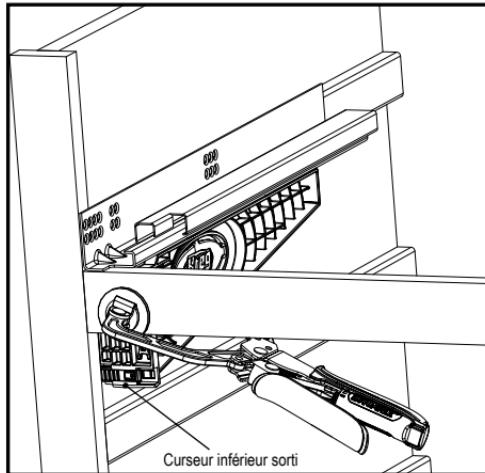
**ATTENTION** N'allongez pas les curseurs inférieurs quand les rebords intérieurs du cadre sont au même niveau que les côtés intérieurs de l'armoire. Fixez les supports aux côtés de l'armoire au moyen des serre-joints. Assurez-vous que le tampon du serre-joint soit appuyé sur l'armature du support et non sur le treillis central de l'armature, y compris le logo Kreg. Fixer le tampon du serre-joint sur le treillis pourrait briser le support.
