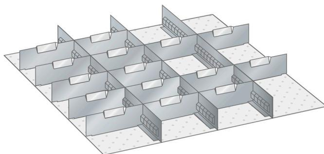
**Trennbleche:** Ermöglichen im Verbund mit den Schlitzwänden eine beliebige Feinunterteilung der Schubladen. Das Beschriftungsfeld ist auf der ganzen Breite abgekröpft und dient zur Aufnahme von Beschriftungsreitern oder Barcode-Trägern. Die untere Abkantung nach vorne ermöglicht ein Verschrauben der Trennbleche mit dem gelochten Schubladen-Boden. Auf jedem Trennblech sind die Masse eingestanz. Ausführung: Aluminium.
